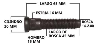
5790-1710 T/ RUEDAS CARGO 815 DELANTERO 5/8-18x90MMx45MMx27MM
